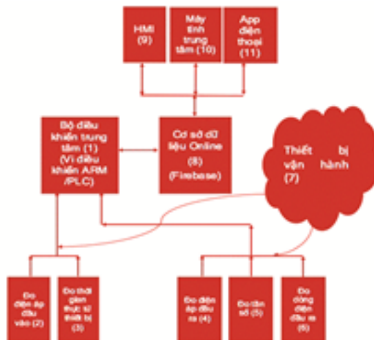
Các bước thực hiện để quản lý và giám sát bộ chuyển đổi công suất cho thiết bị điện gió
